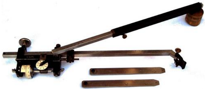
afb. 8 – Compensatiepoolplanimeter Ahrend 573 (Ott)
