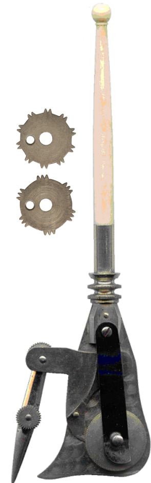
afb. 4 – stippelaar met trekpen en kartelwiel
