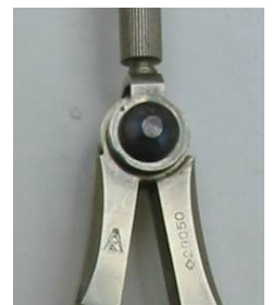
Figuur 5.9: Passer naar systeem Riefler met kopscharnier van Kern uit 1900
