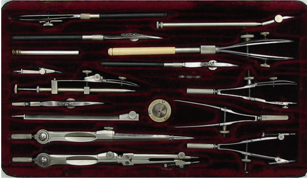
Figuur 5.5: Grote passerdoos met alle genoemde vernieuwingen, 255 x 145 mm
