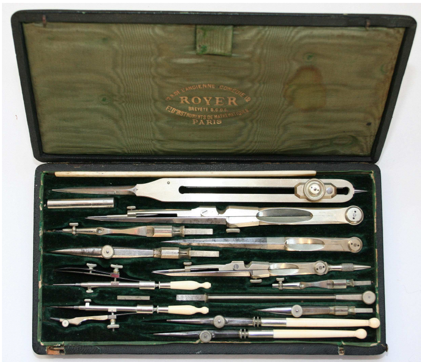
Afbeelding 3a – Passerdoos 237 x 124 mm: reductiepasser met tandheugel, 2 inzetpassers met inzetten, steekpasser, kopschroevensleuteltje, 2 pomppassertjes, 2 trekpenen, stiftenkokertje, benen liniaal 0-15 cm. (Royer, ca. 1870)
