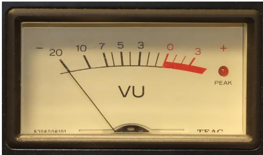
Fig. 3. De VU-meter (Volume Unit) zoals in de jaren zestig en zeventig op veel consumenten audioapparatuur voorkwam. Bij een goed ontworpen VU-meter ligt de waarde -4 dBVU (ook vaak -3 dBVU) precies onder de verticale stand van de wijzer. Deze meter heeft geen dB-aanduiding.
