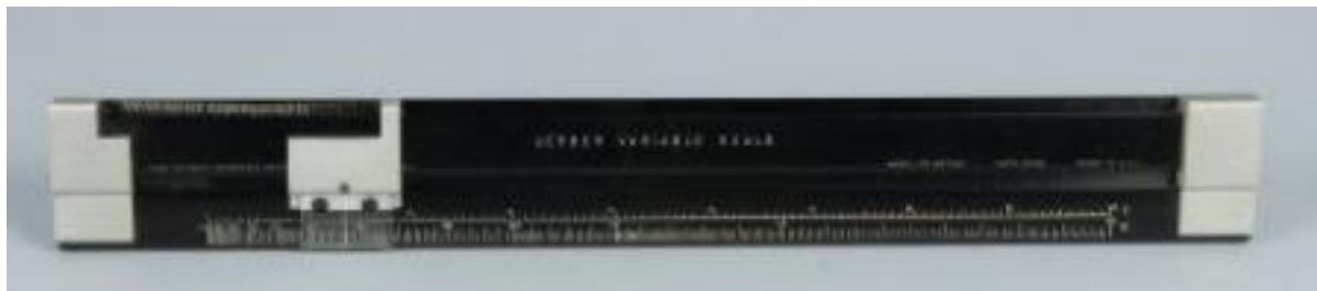
Fig. 6. Een exemplaar van de Gerber Variable Scale met alleen inch- en reciproke schaal.
