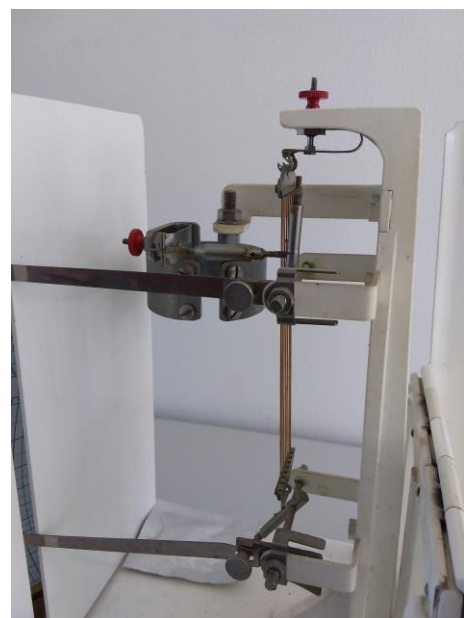
Fig. 8. Links de trommel van de barograaf met het schrijfpapier. Rechts het vergrotende overbrengingsmechanisme.
