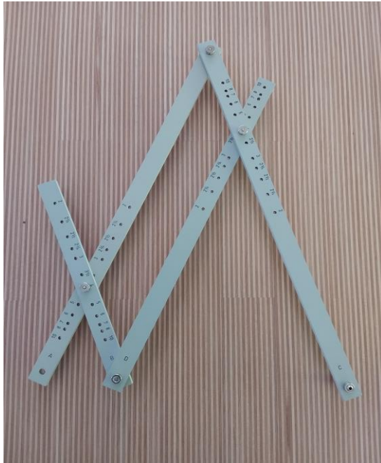
Fig. 2. Een pantograaf, ingesteld op de vergrotingsfactor 4.
