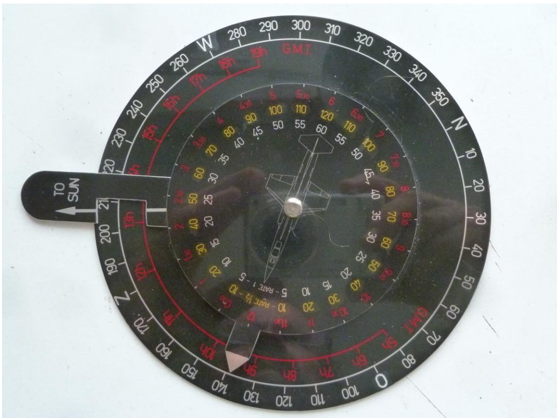
Foto: instrument voor Starfighter, voorzien van label "Zonkompas / Nato stocknr: 6B-5036 / Doc.nr 680701 / KLU-onderdeel DVM I / Inspectiedatum 4-1-61".
