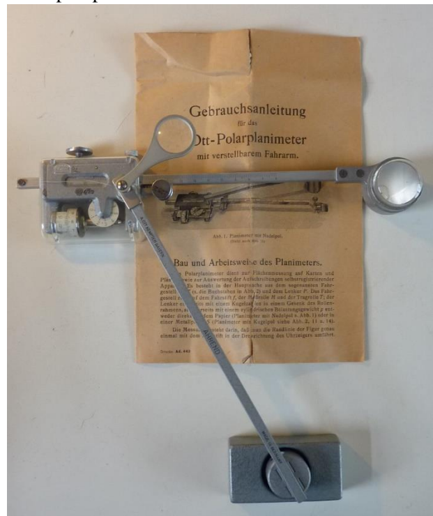
Fig. 2. Poolplanimeter, type 31, nr. 89475, geproduceerd door A. Ott, Kempten, Bayern, op de Nederlandse markt gebracht door N.V. Wed. J. Ahrend & Zoon. Eigendom van de auteur.
