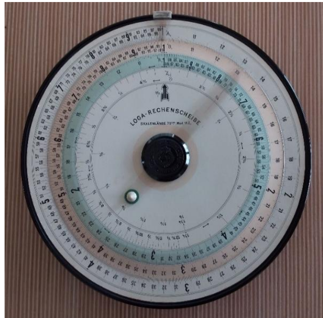
Fig. 7. De bakelieten LOGA rekenschijf 75 cm, Model RZ.
